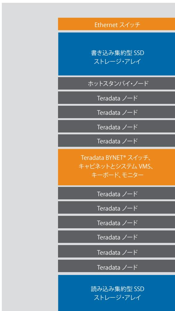
図1.Teradata IntelliFlex プラットフォーム・キャビネットのコンポーネント
